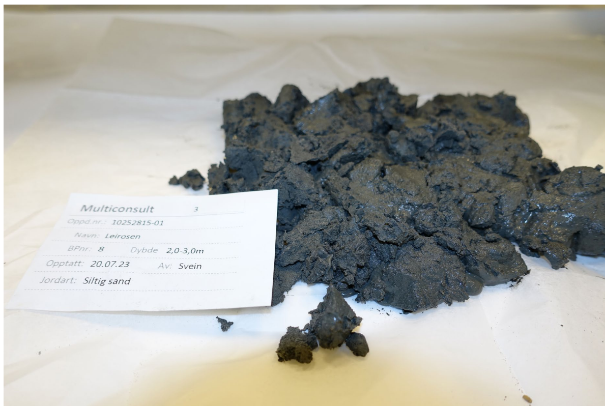
Figur 4-3: Siltig sand med varierende innhold av leire fra poseprøve fra borpunkt 8 ved dybde 2,0-3,0 meter. Et middels vanninnhold 20,9% og dette siltlaget har ikke sprøbruddegenskaper da omrørt skjærfasthet er 2,61 kPa.
