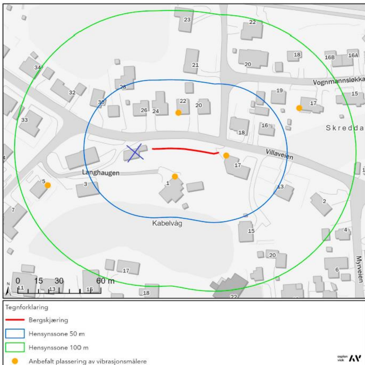
Figur 23 -Anbefalt plassering av vibrasjonsmålere for bergskjæring, samt hensynssoner på 50 m og 100 m. Bygningen med blått kryss over eksisterer ikke lenger.
