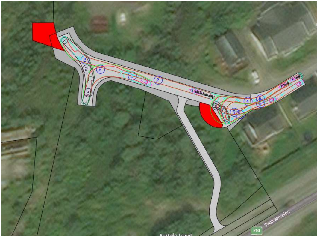
Figur 24. Illustrert areal beregnet for snøopplag for brøyting av veien (vist med rødt), samt sporing for lastebil/brannbil.
