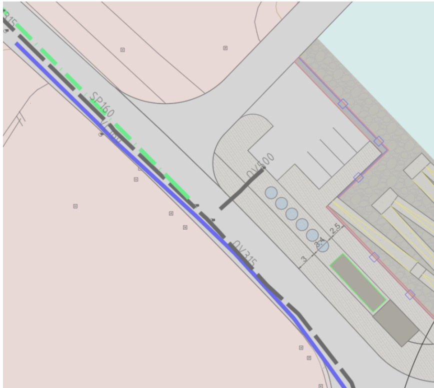
Figur 6 Eksisterende overvannsledning DN500 må forlenges.
