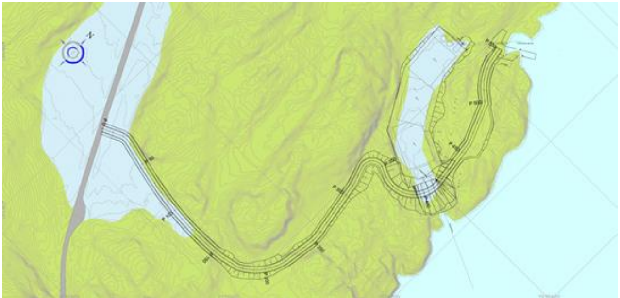
Figur 6: Prosjektert vei med skjæringer og fyllinger.
