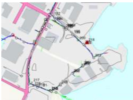
Eksisterende teknisk infrastruktur ved planområdet. Blå= vannledning, grønn= spillvann, svart= overvann, rosa= hovedveg
