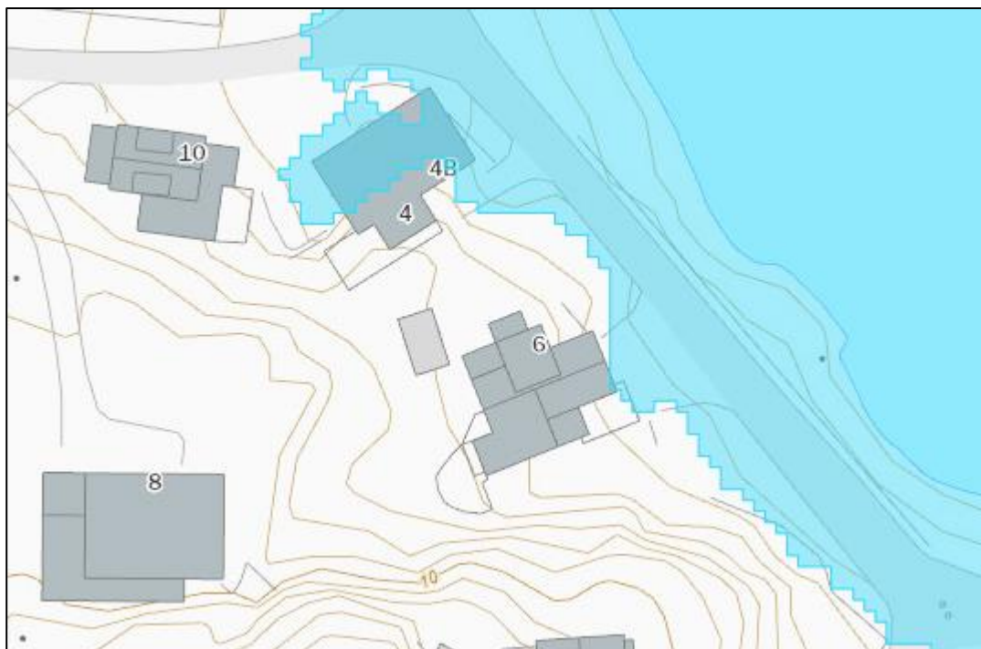
Figur 5 Kart over området med vannstand med 200 års gjentakintervall med klimapåslag inntegnet (3.3 m rel. NN2000, kilde: sehavniva.no). Sikkerhetsklasse F2 iht. TEK 17. Oppdatert februar 2025.
