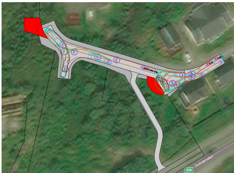
Figur 3 Illustrering av areal beregnet for snødepot ved brøyting av vei, samt spring for lastebil/brannbil.
