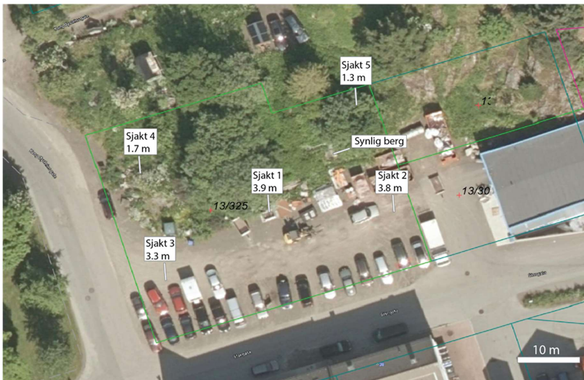
Figur 10: Oversikt over hvor i utbyggingsområder det er tatt prøver samt dybder. Bilde: Norconsult (2021).
