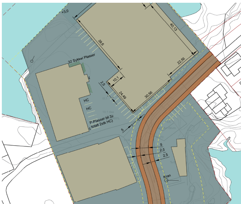
Figur 13 Utsnitt av illustrasjonsplanen som viser hvor parkeringsplasser for bil og sykkel kan plasseres.
