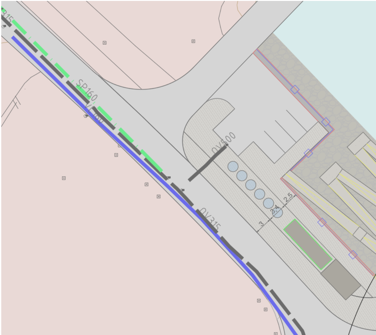
Figur 5: DN500 stikkledning som må forlenges
