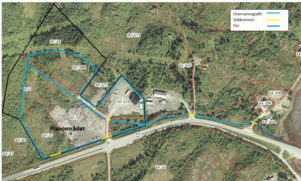
Figur 2 - Anbefalt hovedkonsept for overvannshåndtering, Dreneringsplan utarbeidet av Asplan Viak
