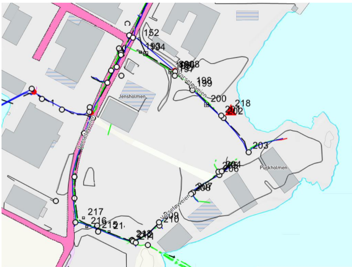
Ekisterende teknisk infrastruktur ved planområdet. Blå= vannledning, grønn= spillvann, svart= overvann, rosa= hovedveg
