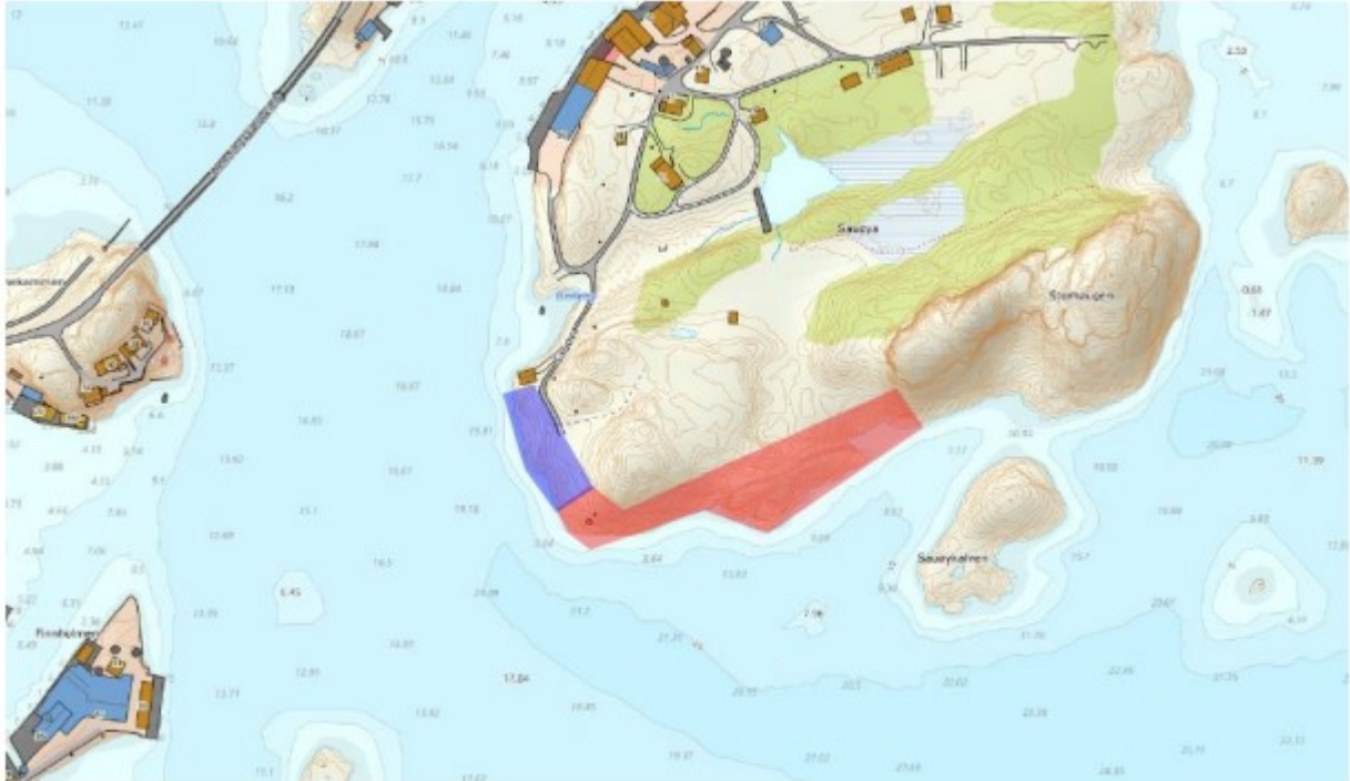
Figur 9: Nødvendig byggehøyde, oppdeling. Rødt felt minimum byggehøyde ca. 9 meter, blått felt minimum byggehøyde ca. 7 meter.
