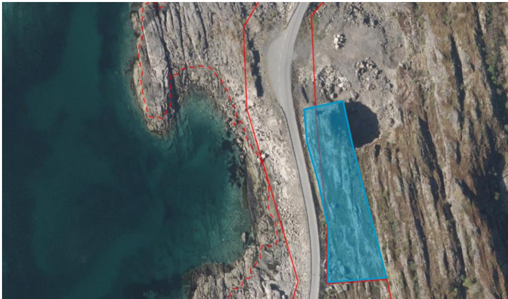
Område på ca. 2600 m 2 for uttak av masser til nytt fortau.
