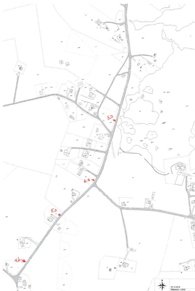
Illustrasjon over viser målt asfaltert vegbredde
