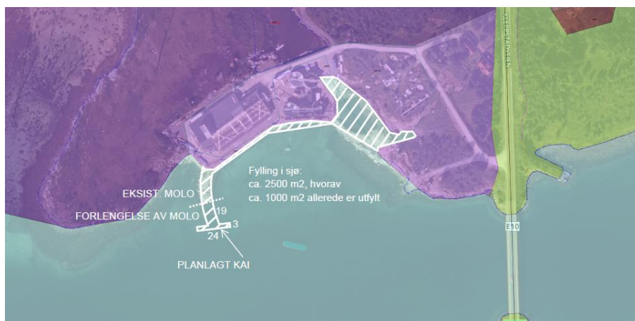
Fyllinger i sjøen utenfor avsatt næringsareal, vist med hvit skraver
