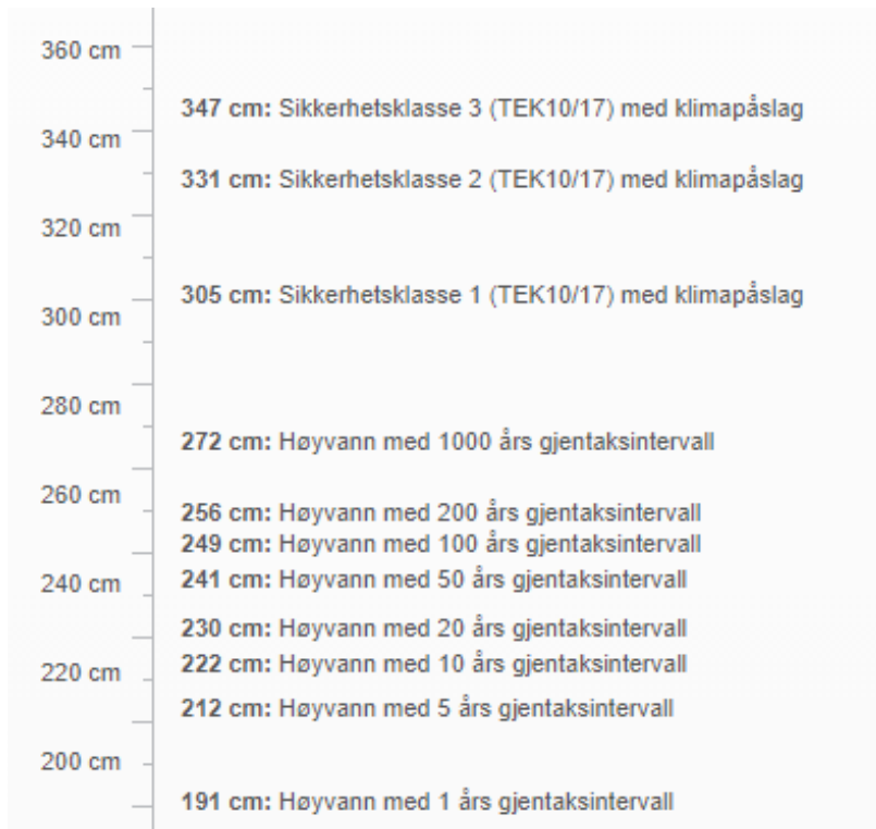
Figur 6: Returnivå ihht. DSBs anbefalinger for Henningsvær (sikkerhetsklasse 1 – 3, RP = 200 år), samt gjentaksintervall ved høyvann for 2020 (alle kotehøyder basert på NN2000). [4]
